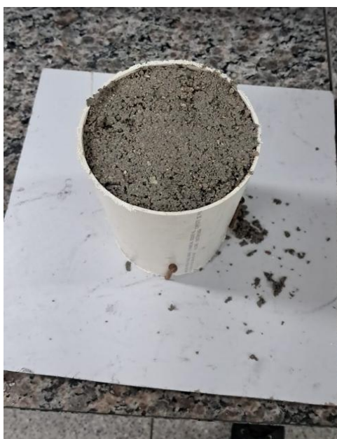
Figura 6 – Concreto moldado no cano de PVC
