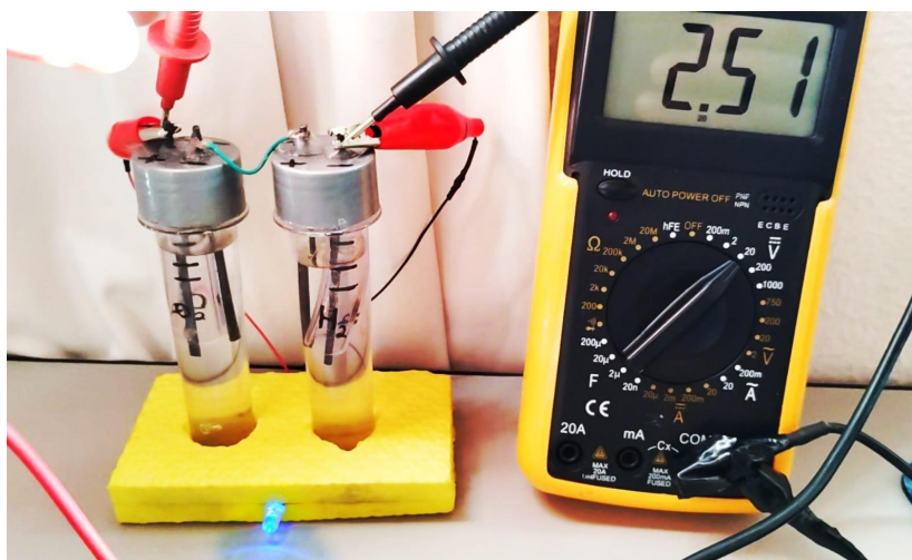
FIGURA 2 – O hidrogênio armazenado durante o experimento gera energia para acender uma lâmpada de LED. A tensão medida nos eletrodos foi de 2,51 Volts.
