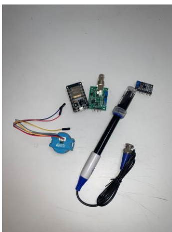
Figura 6: Kit IoT para monitoramento da turbidez e pH da água. (Elaborado pelo autor, 2024)
