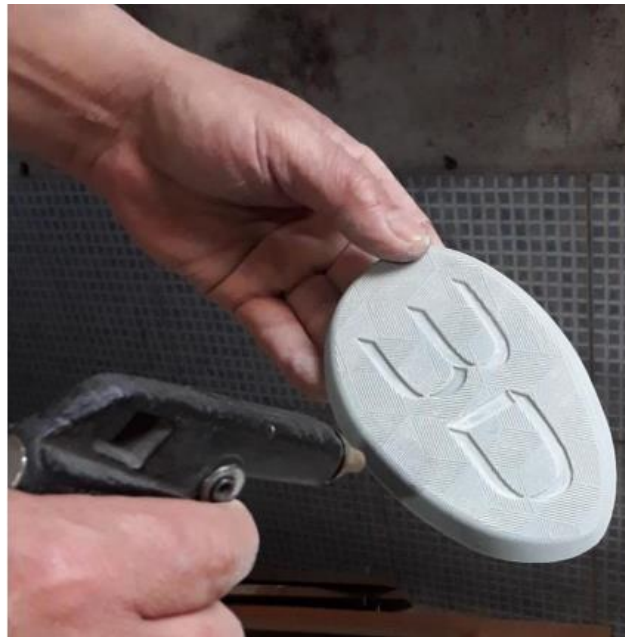
Processo de ar, responsável por retirar poeiras aderidas às peças. Após, inicia-se a pintura. Fonte: Perini 3D, 2022.
