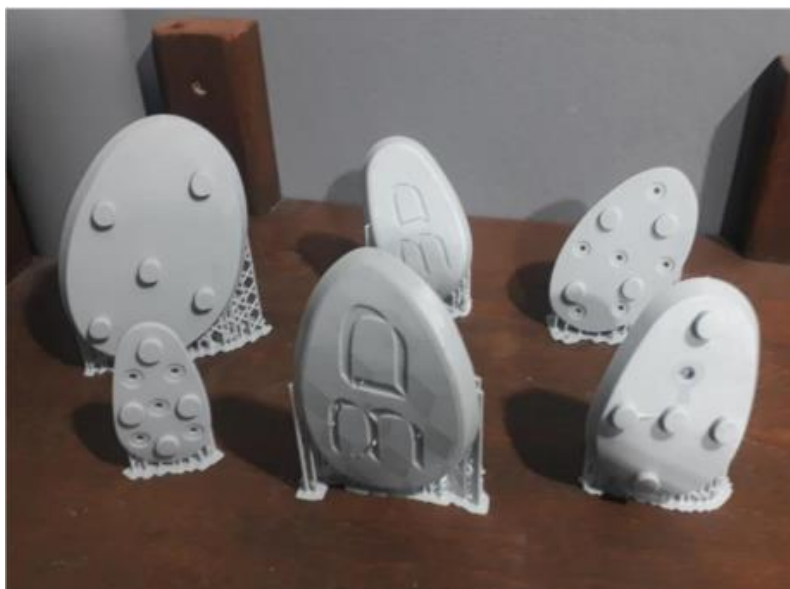
Peças (solas) diretamente após saírem da máquina de impressão: em seguida, realiza-se um processo de limpeza e cura das partes. Fonte: Perini 3D, 2022.
