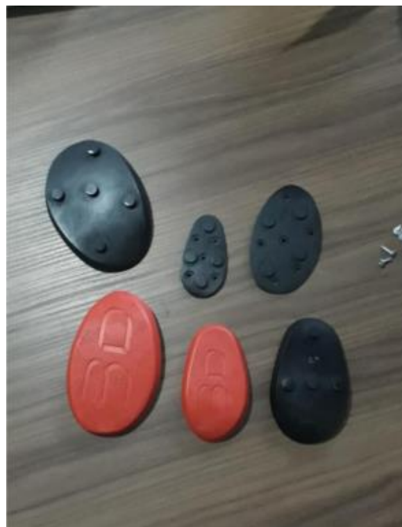
Acabamento final das solas (foto posterior à pintura). Fonte: Perini 3D, 2022.
