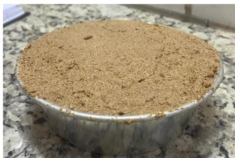
Figura 23. Material compactado no molde.
