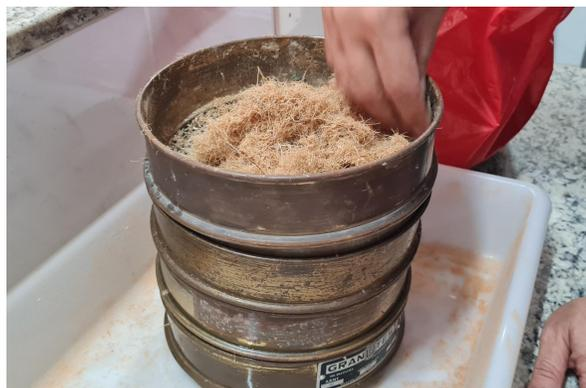
Figura 7. Fibra sendo peneirada.
