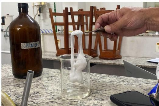
Figura 12. Isopor diluído por thinner, seco e resistente formando uma goma.
