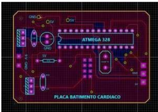
Figura 5 – Construção da placa no Software Proteus
