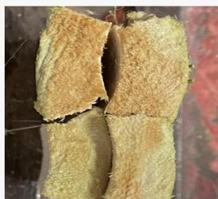
Figura 2: Peças menores divididas com o auxílio de uma prensa.
