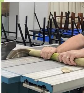
Figura 1: Corte do bambu com uma serra circular.
