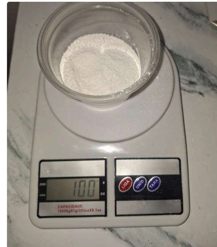
Imagem 4: Pesagem de caulim em balança digital.
