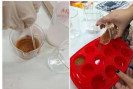
Fase inicial dos testes: mistura não homogênea.
