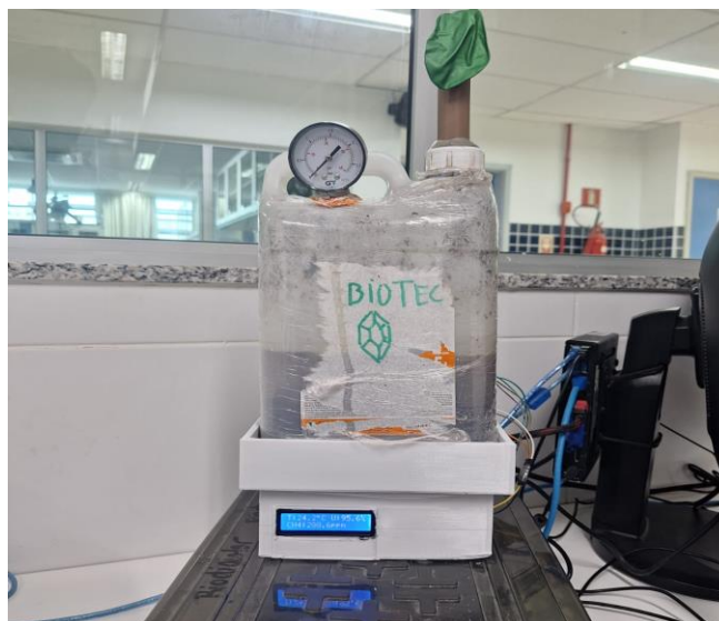
Figura 3 – Fotografia do Biodigestor Biotec em funcionamento
