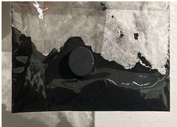
Figura 12 - Fotografia da força magnética exercida pelas nanopartículas de ferro ( \text{Fe}_3\text{O}_4 ) adsorvidas em carvão vegetal ativado.
