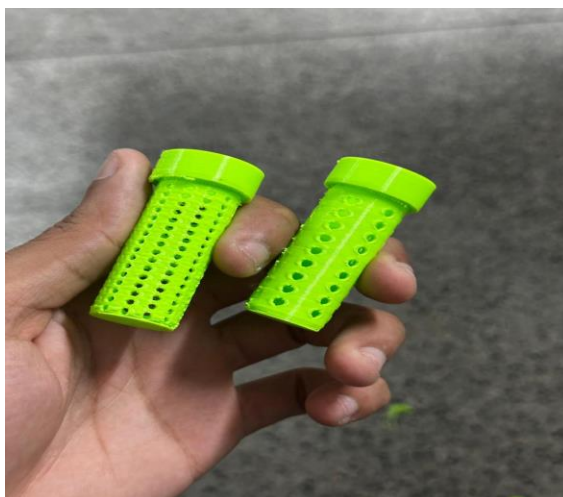
Figura 11 - Fotografia do filtro em PLA impresso em 3D
