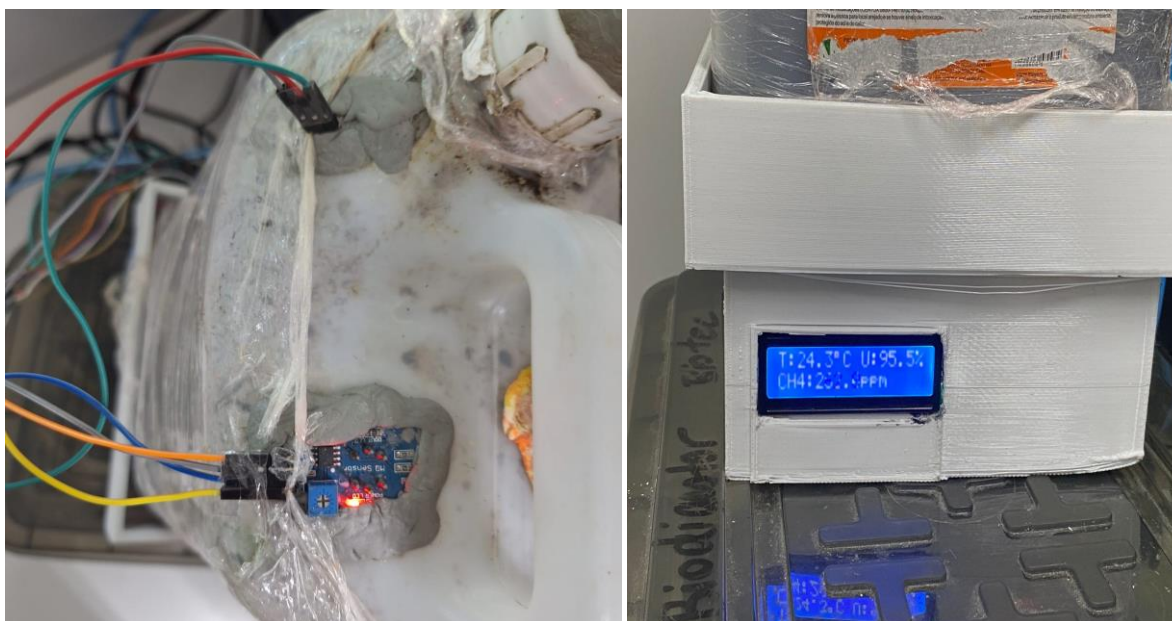
Figura 5 e 6 – Fotografias da conexão dos sensores MQ-4 e DHT22 ao Arduino UNO e sua integração ao sistema do biodigestor.
