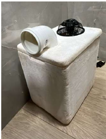
Figura 5: climatizador montado, fechado e colocado dentro do banheiro em que será testado.
