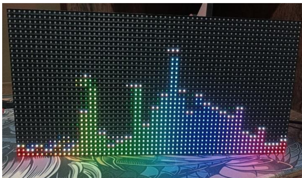
Figura 6 – Resultado do protótipo em funcionamento, reagindo a um estímulo musical. Fonte: Elaborada pelos autores.
