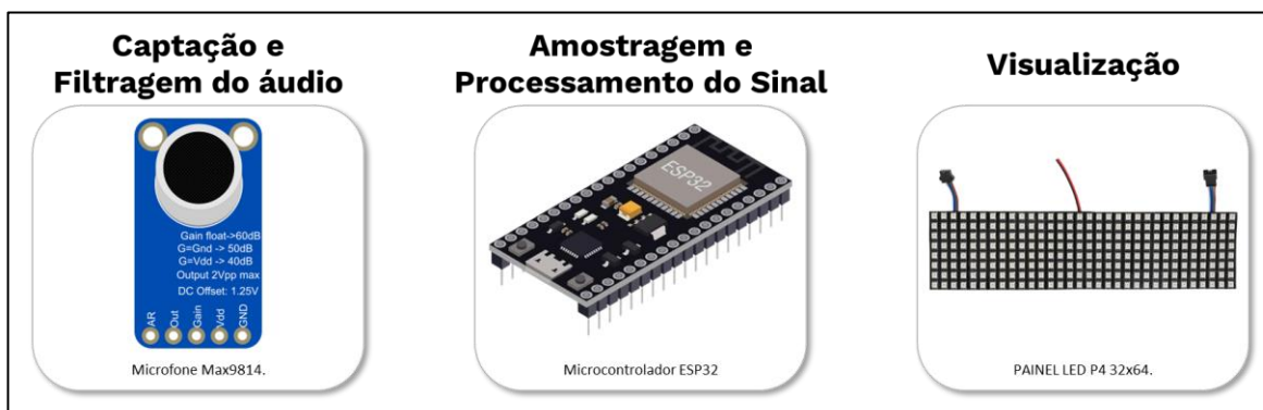
Figura 2 – Principais componentes e funções no projeto. Fonte: Elaborado pelos Autores.
