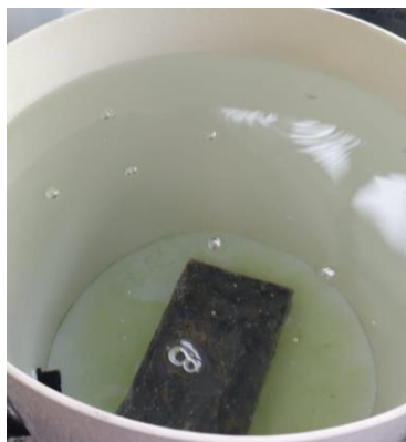
Figura 20 - Paver ECOPLASF submergido
