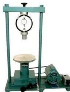
Figura 22 - Prensa de Marshall 29
