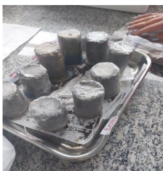
Figura 18 - Película aplicada nas amostras para o ensaio de compressão
