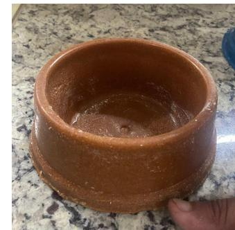
Figura 1: comedouro à base de fibra e resina
