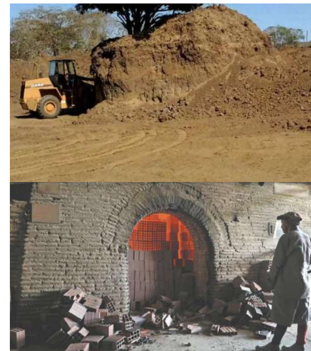
Figura 1 - Retirada de argila e queima de lenha no processo de cura dos tijolos
