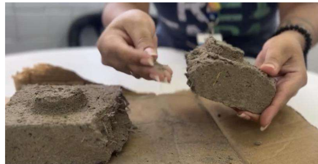
Figura 2 - Tijolo quebradiço feito na primeira produção
