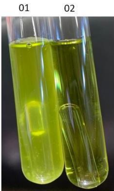
Figura 12: Amostra de água não tratada (01) e amostra de água tratada (02) inoculadas em meio verde brilhante mostrando turbidez e presença de gás no tubo de durhan evidenciando crescimento microbiano apenas na amostra de água não tratada
