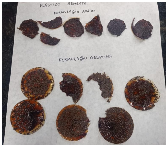
Figura 7 - Resultado dos plásticos com chorume obtidos na segunda formulação testada
