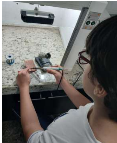
Figura 18– Início da soldagem do ESP 32, RTC e Módulo SD card.
