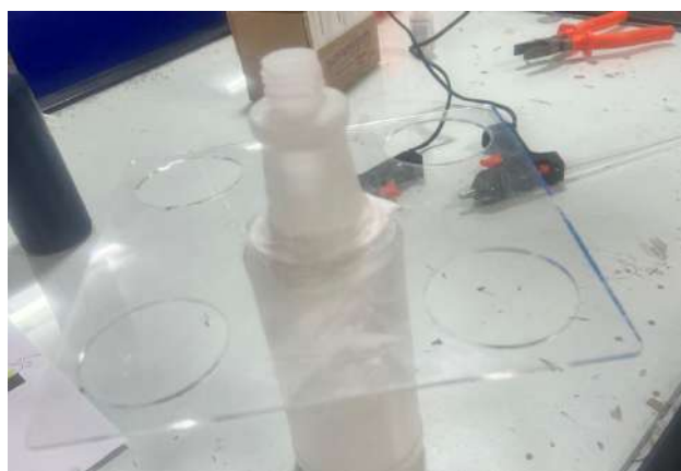
Figura 24 – Placa de acrílico recortada sendo colada a garrafa central de 1,5L.
