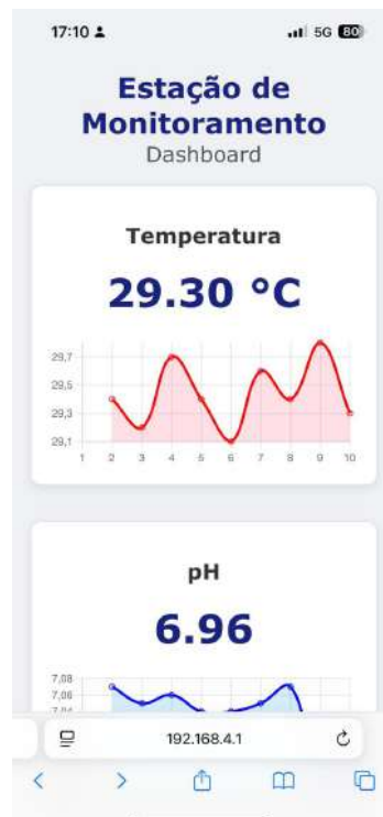
Figura 16 – Dashboard do ESP 32 exibindo valores dos sensores.
