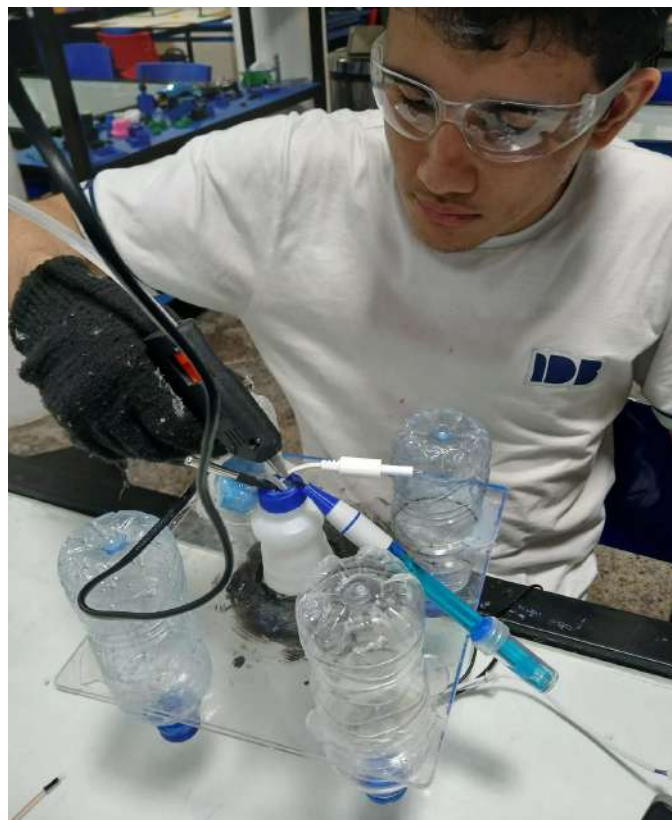
Figura 27 – Isolamento da parte eletrônica na garrafa central.
