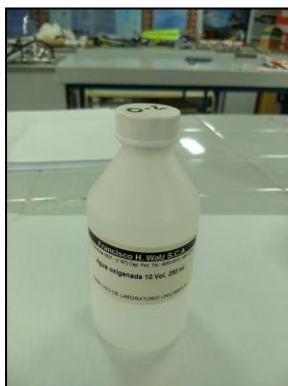
Fig. 6. Agua oxigenada para determinar matéria orgânica.
