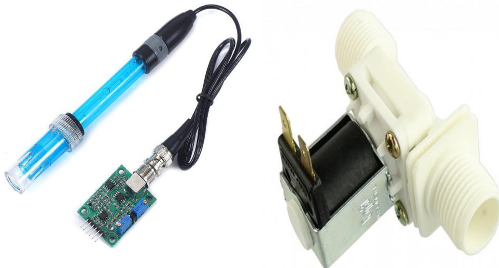
Figura 04 – Eletrodo de pH e válvula solenóide
