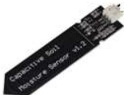
Figura 3. Sensor de umidade capacitivo de solo.
