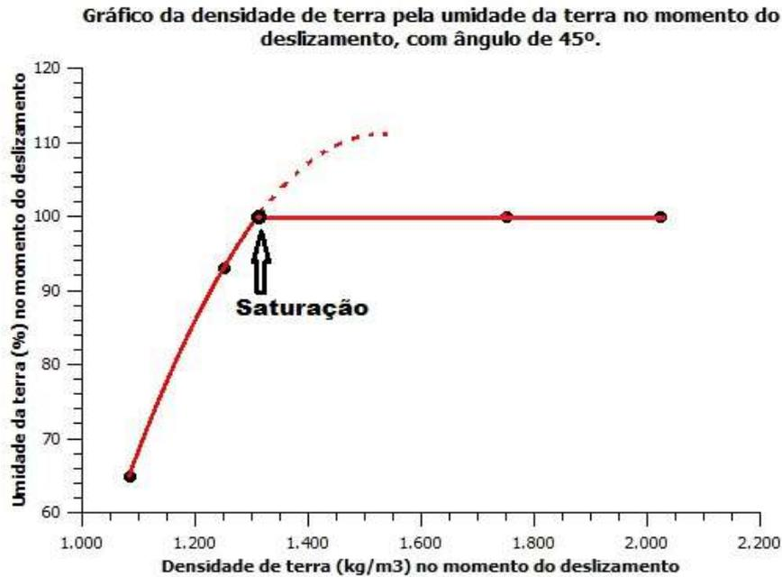
Figura 15. Gráfico da umidade pela densidade da terra no momento do deslizamento, ângulo de 45°.
