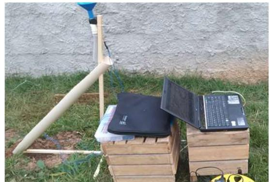
Figura 14. Aparato com a calha fixada em 45°. Realização das simulações de deslizamento.
