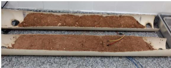
Figura 13. Calhas com terra, e os sensores de umidade no fundo das calhas, embaixo da terra.
