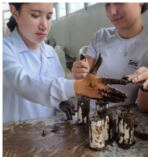
Figura 23 - Preenchimento dos canos de PVC
