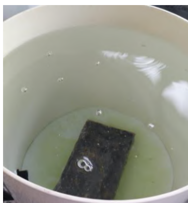
Figura 27 - Paver ECOPLASF submerso
