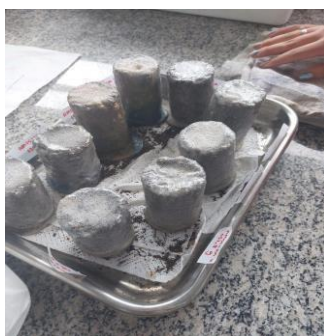
Figura 25 - Película aplicada nas amostras para o ensaio de compressão
