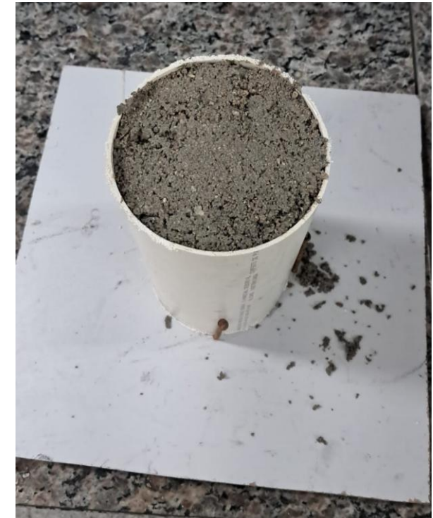
Figura 5 – Protótipo montado utilizando o cano como molde.
