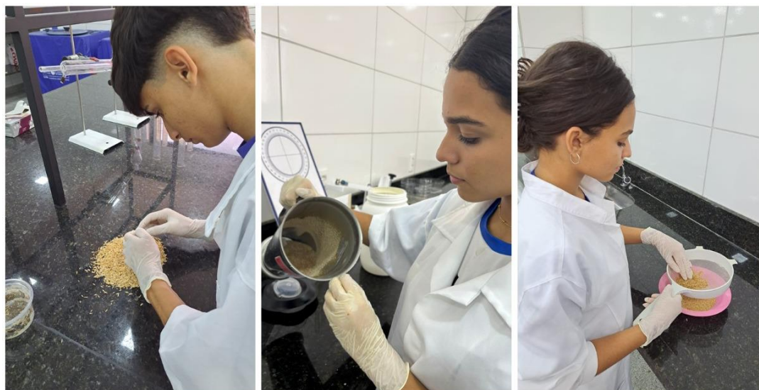
Figura 05: Etapas de produção da sílica de casca de arroz
