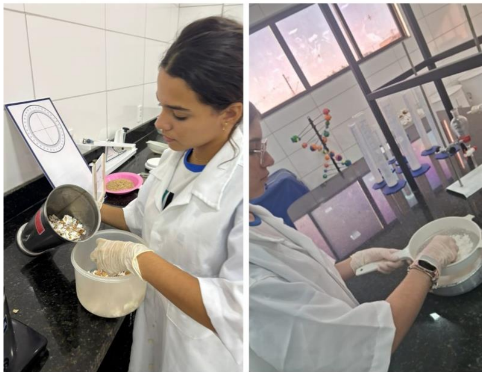
Figura 04: Caracterização das cascas de arroz como agregado miúdo
