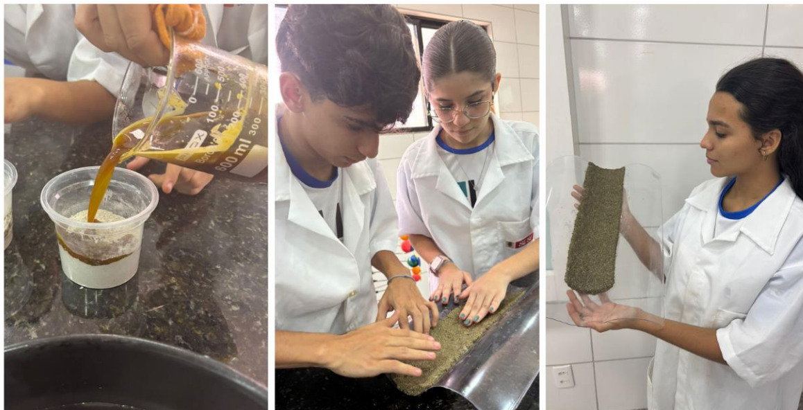
Figura 10: Etapa de moldagem da telha
