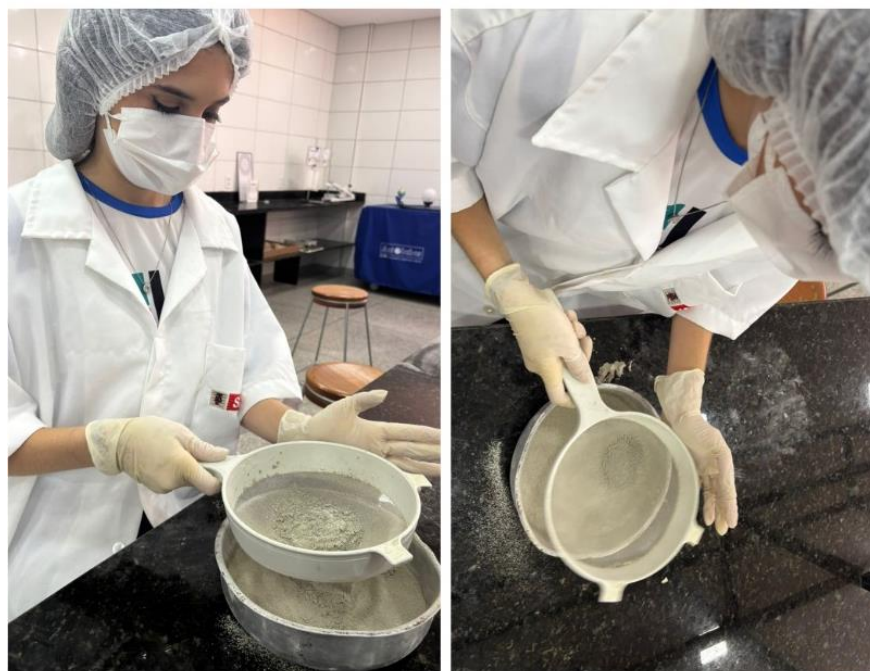
Figura 07: Peneiração do calcário filler a fim deste obter a forma de agregado miúdo
