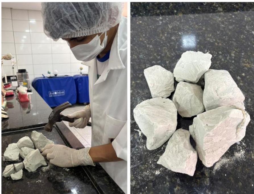
Figura 06: Fragmentação do calcário filler em exemplares pequenos
