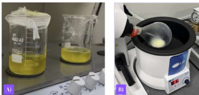
Figura 4 - Soluções preparadas de zeína com ácido úsnico antes da adição do antissolvente (A) e remoção do solvente orgânico em evaporador rotativo (B). Fonte: Autores, 2025.
