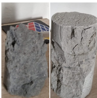
Figura 3: Blocos de cimentos colapsados após o teste de pressão
