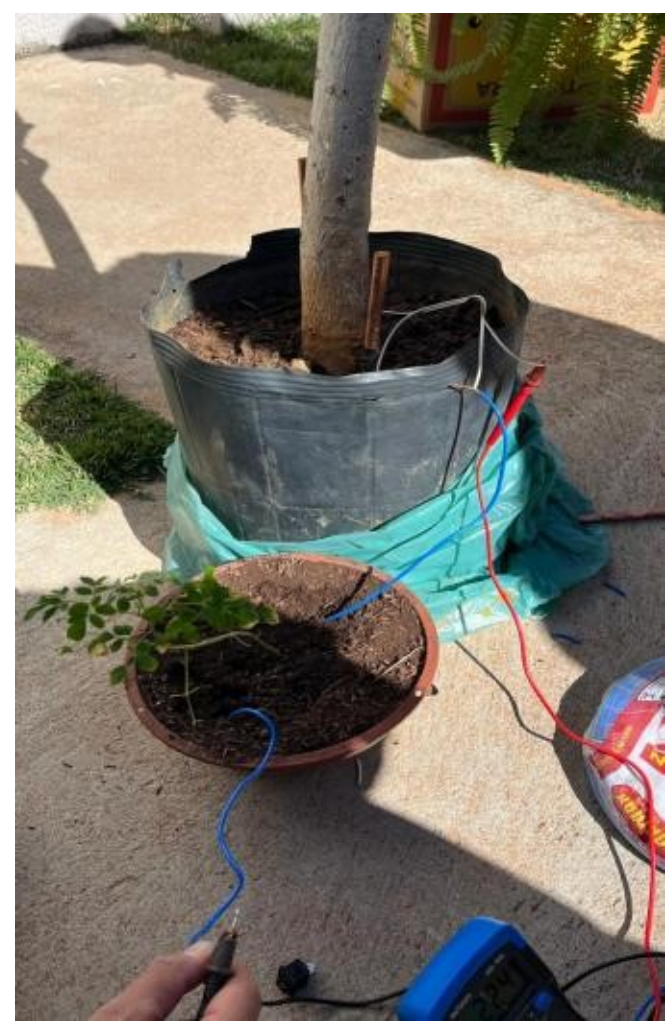
Figura 1- Demonstração de teste de produção de energia com a ligação em série
