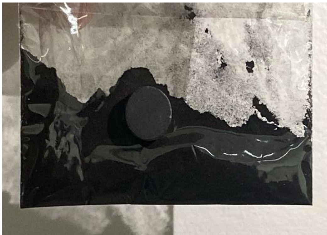
Figura 3: Filtro de Carvão magnetizado com nanopartículas
