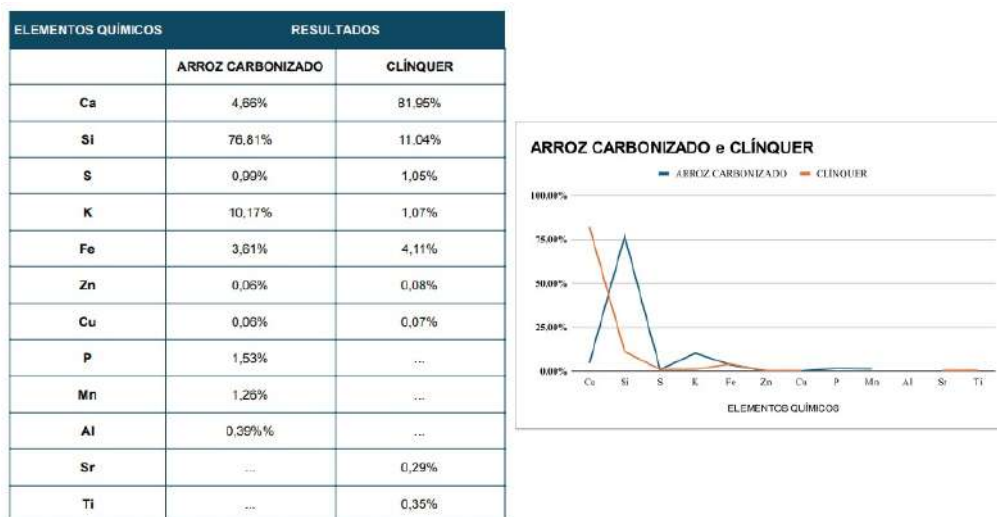
Figuras 14 e 15 - Resultados da Análise do EDX-720 para arroz carbonizado e clínquer
