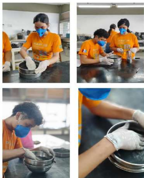
Figura 39 a 42 - Processo de peneiração na peneira ABNT malha 0,075 mm
