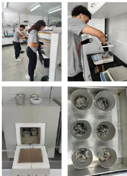
Figura 1 a 4 - Etapas da preparação das biomassas – pesagem e calcinação
