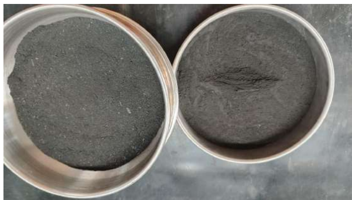
Figura 43 - A esquerda da imagem, observa-se a amostra sem a granulometria adequada; à direita, a amostra após a passagem pela peneira ABNT de 0,075 mm
