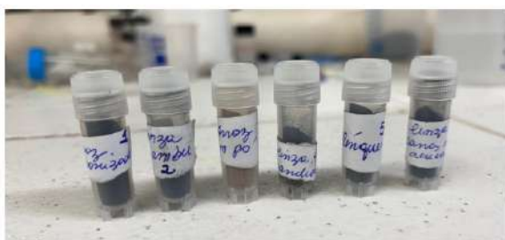
Figura 5 - Amostras das biomassas – cinza da casca de mandioca, cinza do bagaço de cana-de-açúcar, arroz triturado, arroz carbonizado e clínquer
