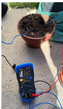
Gráfico 3 - Volts atingidos com a ligação em série das moringas
