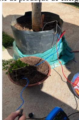
Figura 1 - Demonstração de teste de produção de energia com ligação em série
