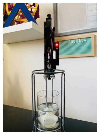
Figura 3. Luz vermelha indicando alto nível de água.
