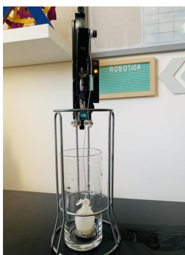
Figura 2. Luz amarela indicando baixo nível de água.
