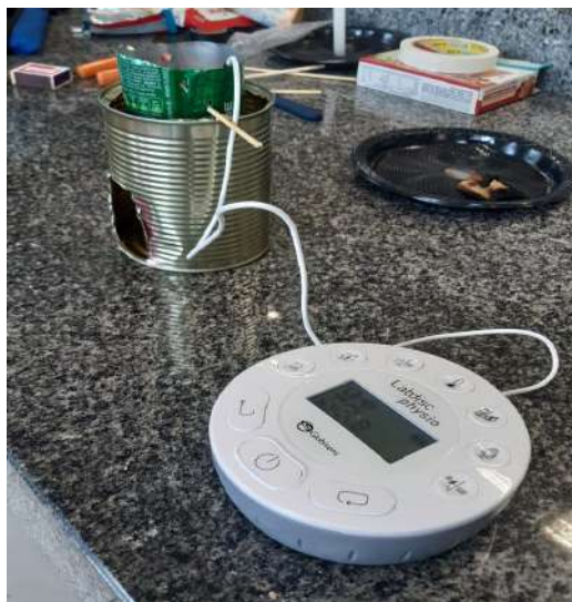
FIGURA 2 - Calorímetro rudimentar e Labdisc Physio, usados para a calorimetria.
