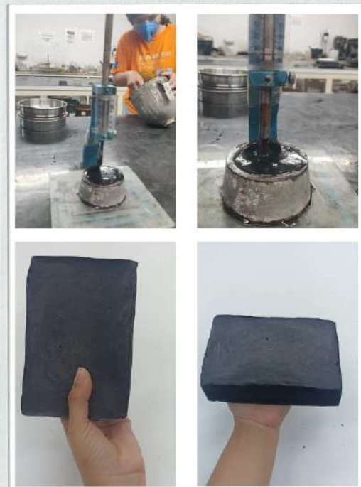
calibração da sonda Tetmajer + observação da amostra após a solidificação.
