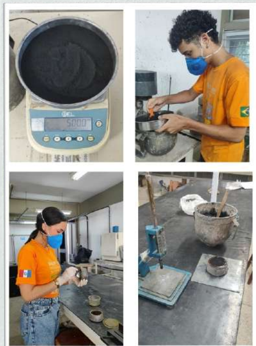
Preparação para o teste de consistência + pesagem do material.
