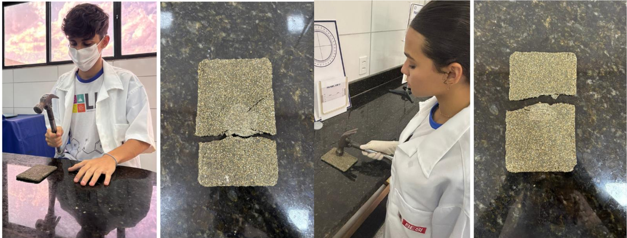
Figura 08: Teste de resistência a impacto com os protótipos 07 e 09
