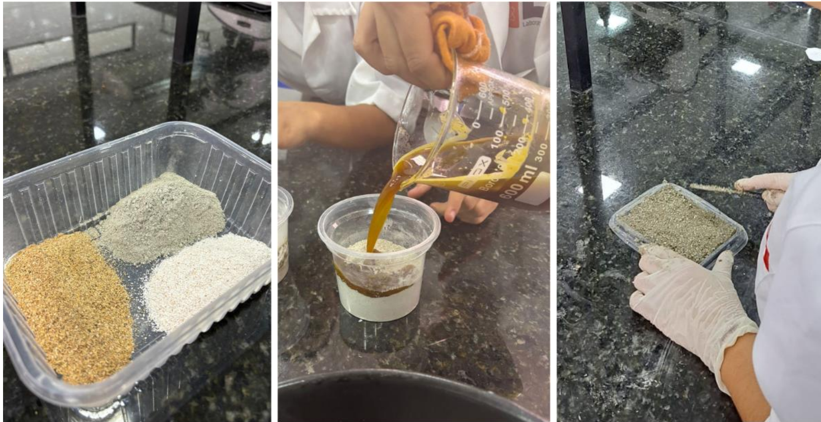
Figura 05: Compostos do cimento alternativo antes da mistura, momento de união com a resina vegetal e moldagem em forma.
