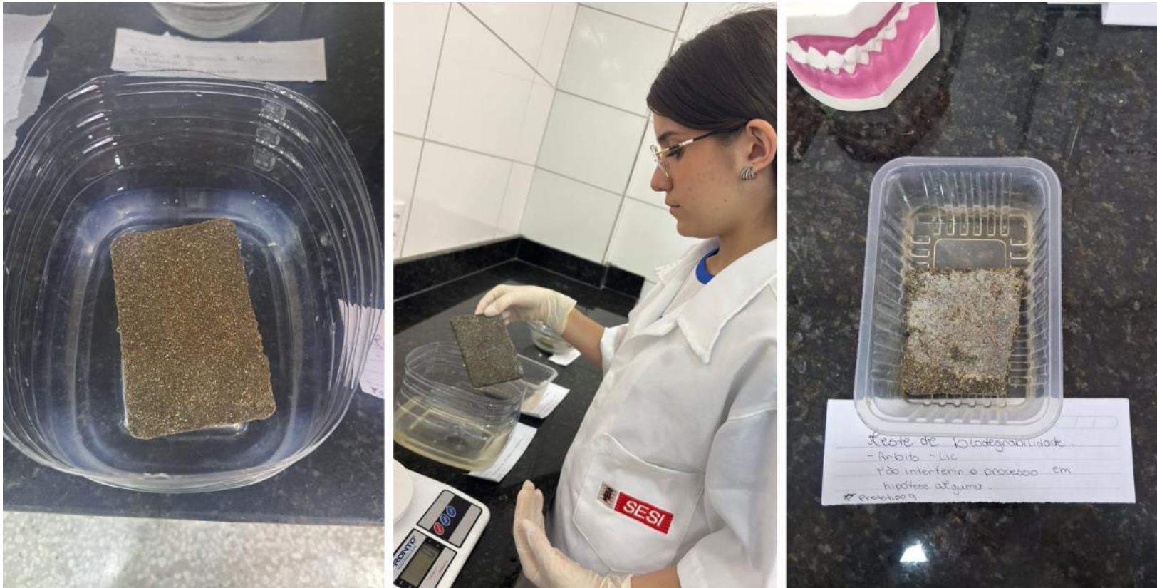
Figura 07: Teste em água doce durante o período de 08 dias, sendo analisados, fotografados e pesados
