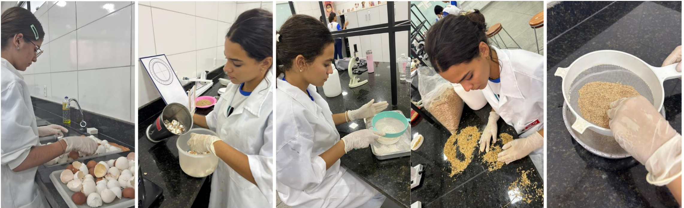
Figura 03: Seleção, esterilização e preparação das cascas de ovos e caracterização das cascas de arroz como agregado miúdo
