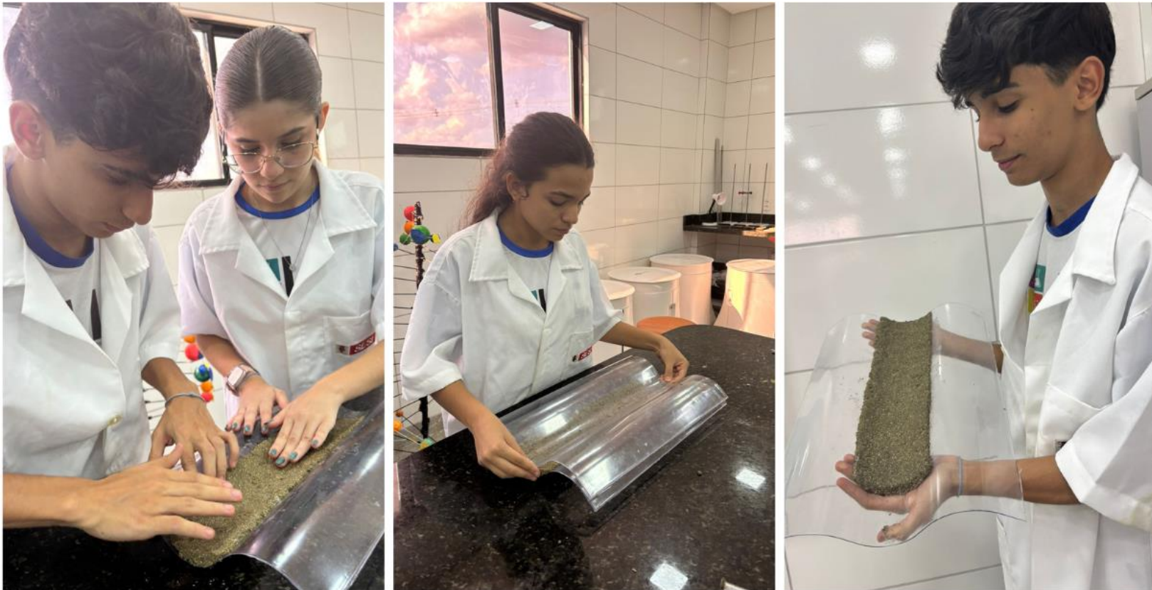
Figura 06: Aplicação do cimento alternativo e moldagem em uma forma apropriada para telhas
