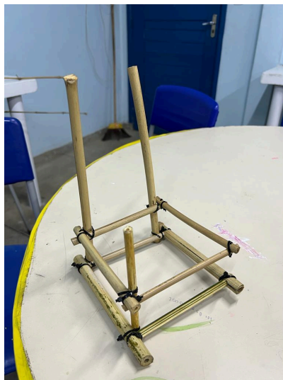
Figura 1 – Montagem da Estrutura da cadeira com bambu
